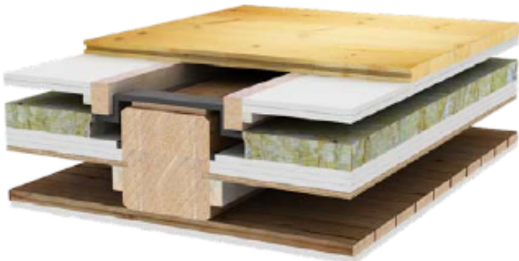
Lydisolering med ny gulvkonstruktion udført "ovenfra"
